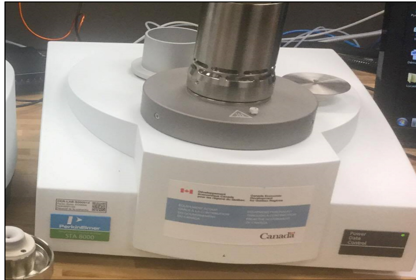
Figure 4.18 Analyseur thermogravimétrique « STA 8000 » de marque Perkin Elmer
